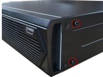
Remove M4 screws highlighted (2 each side)
